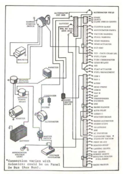
FIGURE 7-3 ELECTRICAL SYSTEM SCHEMATIC
